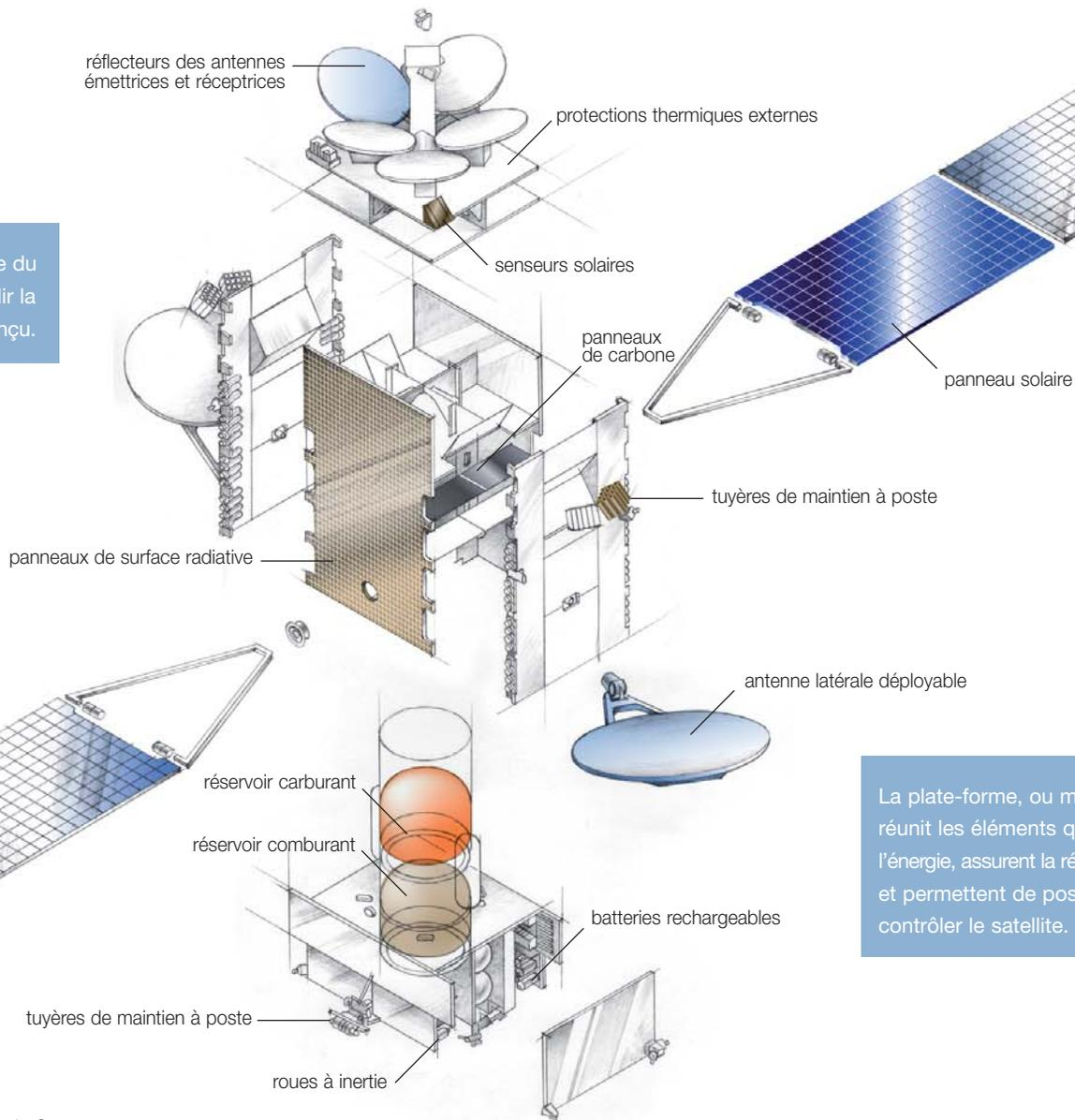
La plate-forme, ou module de service, réunit les éléments qui fournissent l'énergie, assurent la régulation thermique et permettent de positionner et de contrôler le satellite.
