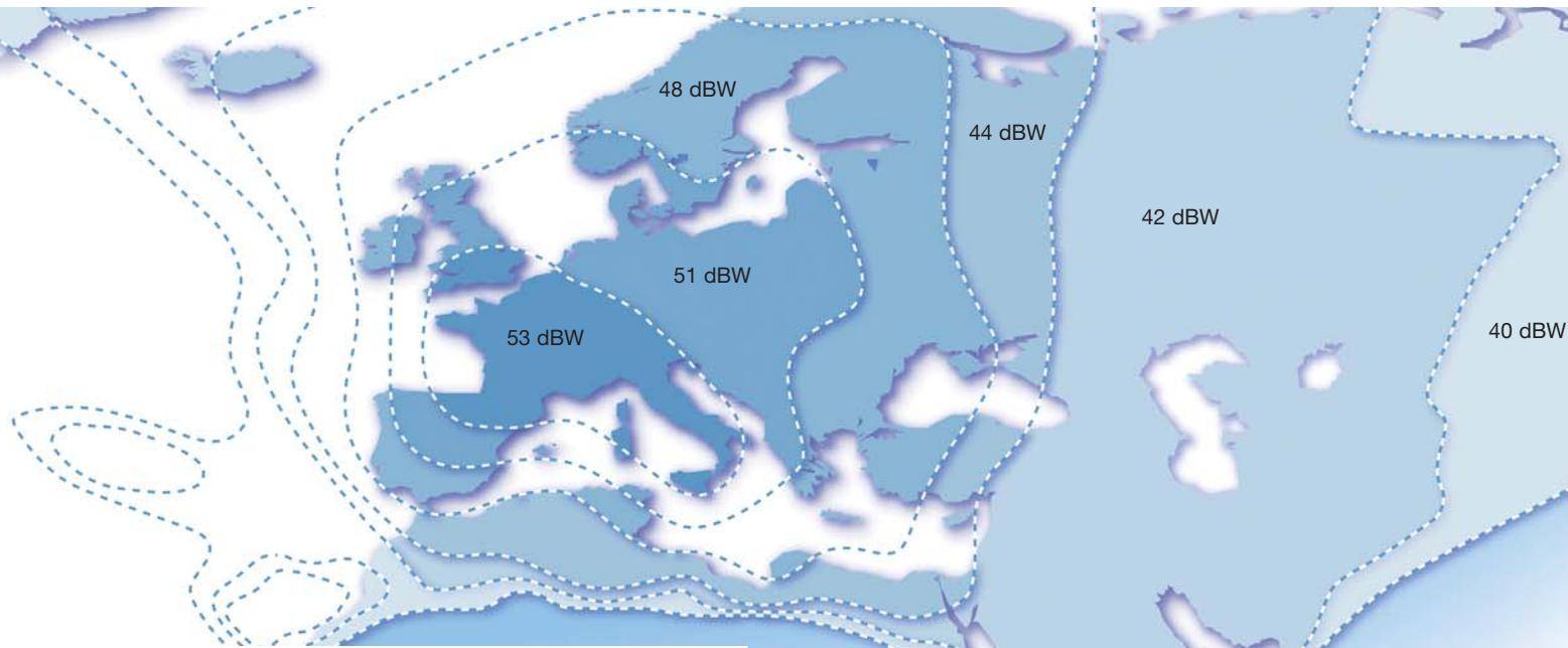
Les conditions climatiques de la zone à desservir privilégient l'usage de certaines bandes de fréquences. Les plus basses fréquences offrent une meilleure résistance à la rencontre de fortes pluies et les plus hautes permettent de réduire la taille des antennes au sol.
