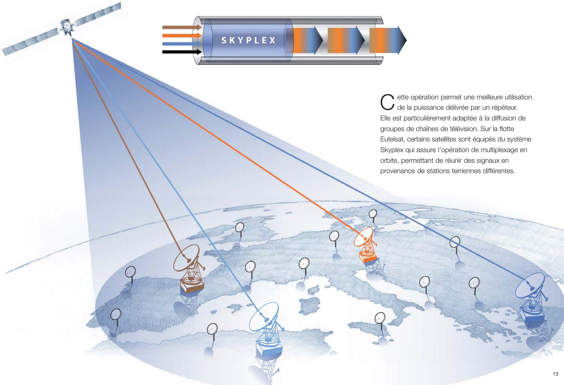
Cette opération permet une meilleure utilisation de la puissance délivrée par un répéteur. Elle est particulièrement adaptée à la diffusion de groupes de chaînes de télévision. Sur la flotte Eutelsat, certains satellites sont équipés du système Skyplex qui assure l'opération de multiplexage en orbite, permettant de réunir des signaux en provenance de stations terriennes différentes.
