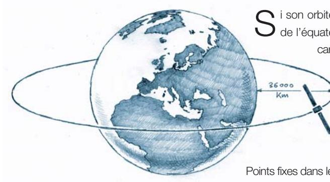
Si son orbite est parfaitement circulaire et dans le plan de l'équateur, alors ce satellite est dit géostationnaire car il semble parfaitement immobile dans le ciel à tout observateur au sol. Cette immobilité n'est qu'apparente, en fait il se déplace à plus de 3 km par seconde.
